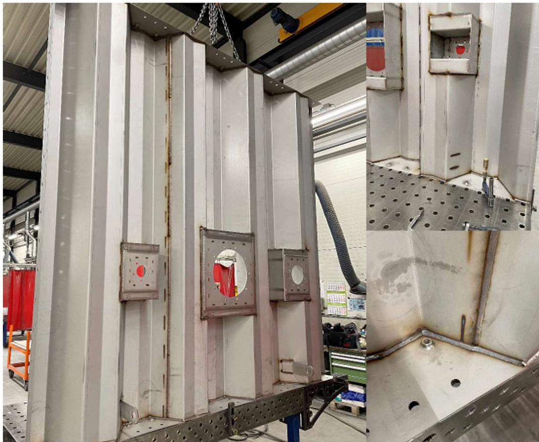
Rys. 2 Panele z kontrolowanymi punktami przełamania
