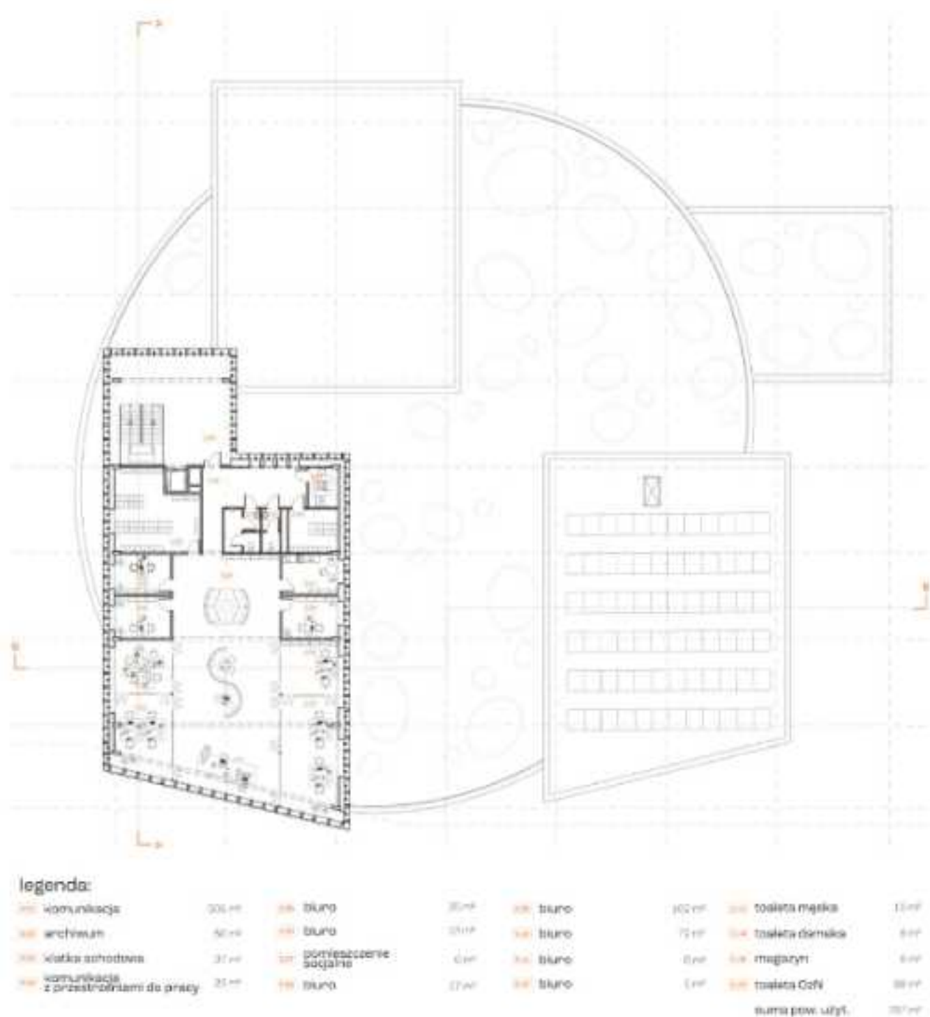
Rys. 16.5. Rzut trzeciego piętra z zestawieniem pomieszczeń i powierzchni.
