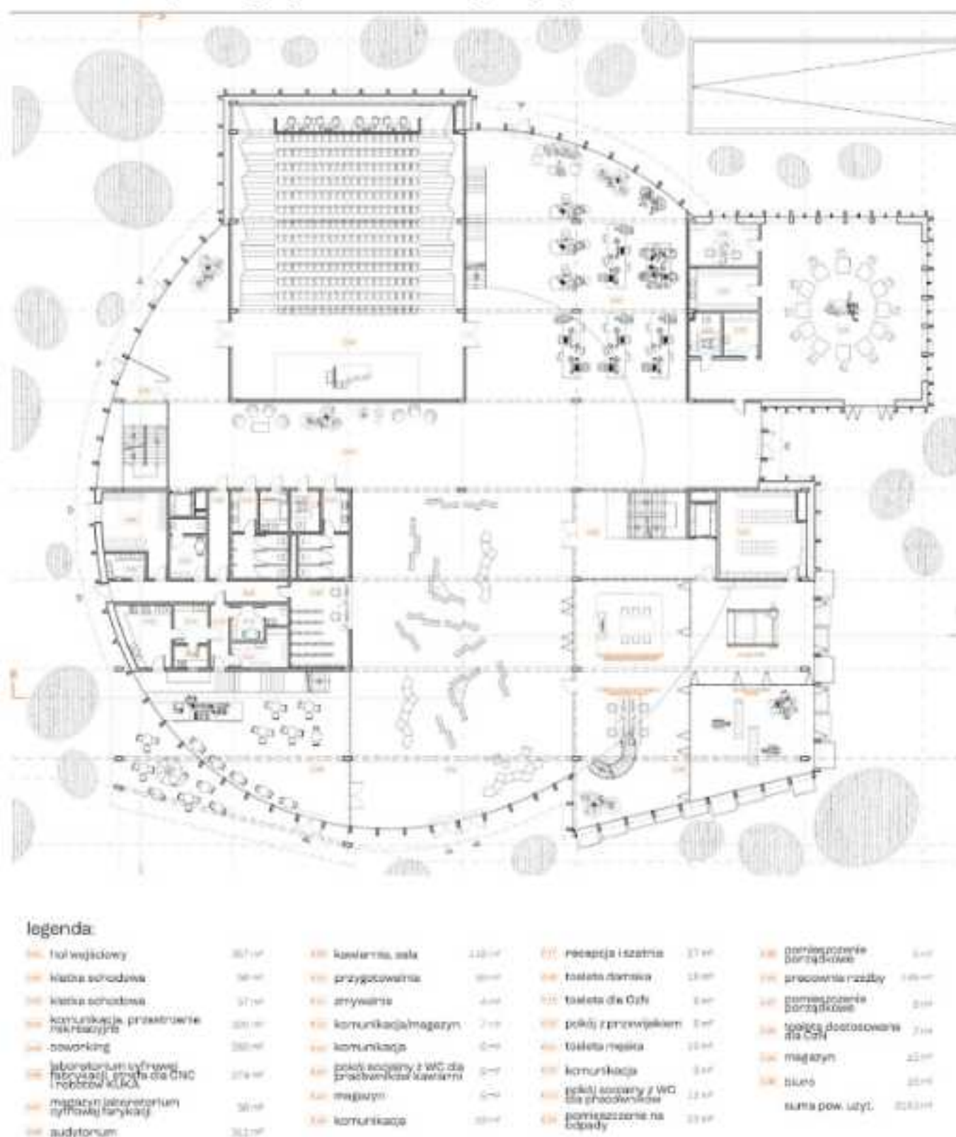
Rys. 16.1. Rzut parteru z zestawieniem pomieszczeń i powierzchni.
