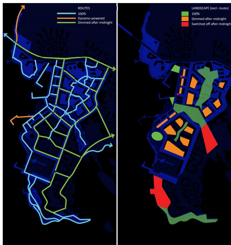
Rys. 4.20. Sposób działania systemu sterowania oświetleniem w Helsinkach Źródło: Luonnon Lyhdyt, Speirs+Major, West 8 Urban Design, 2013
