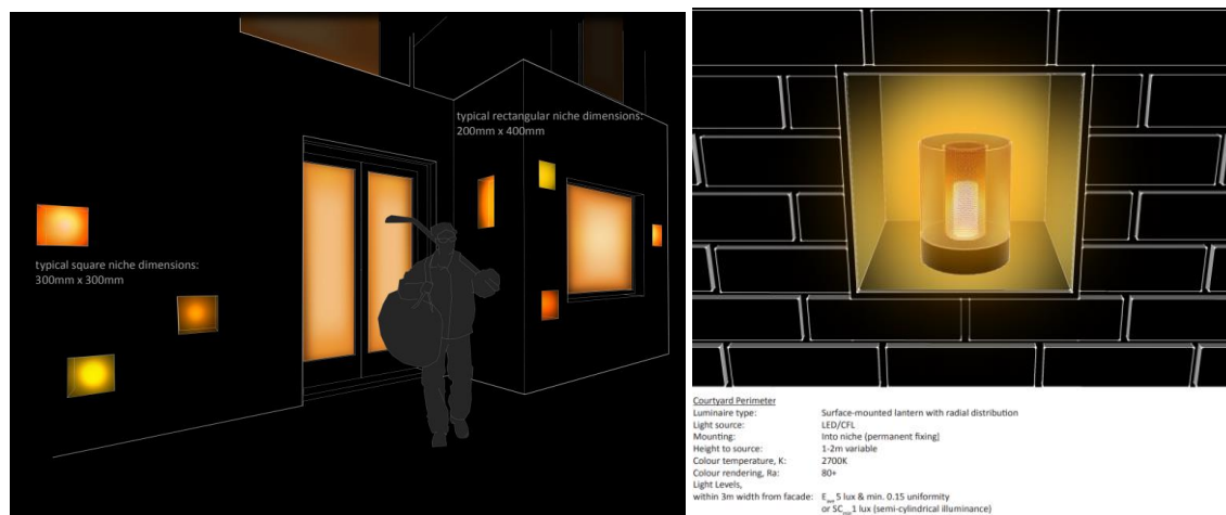
Rys. 4.21. Projekt specjalnej wnęki na latarnie w elewacji budynku w Helsinkach Źródło: Luonnon Lyhyt, Speirs+Major, West 8 Urban Design, 2013
