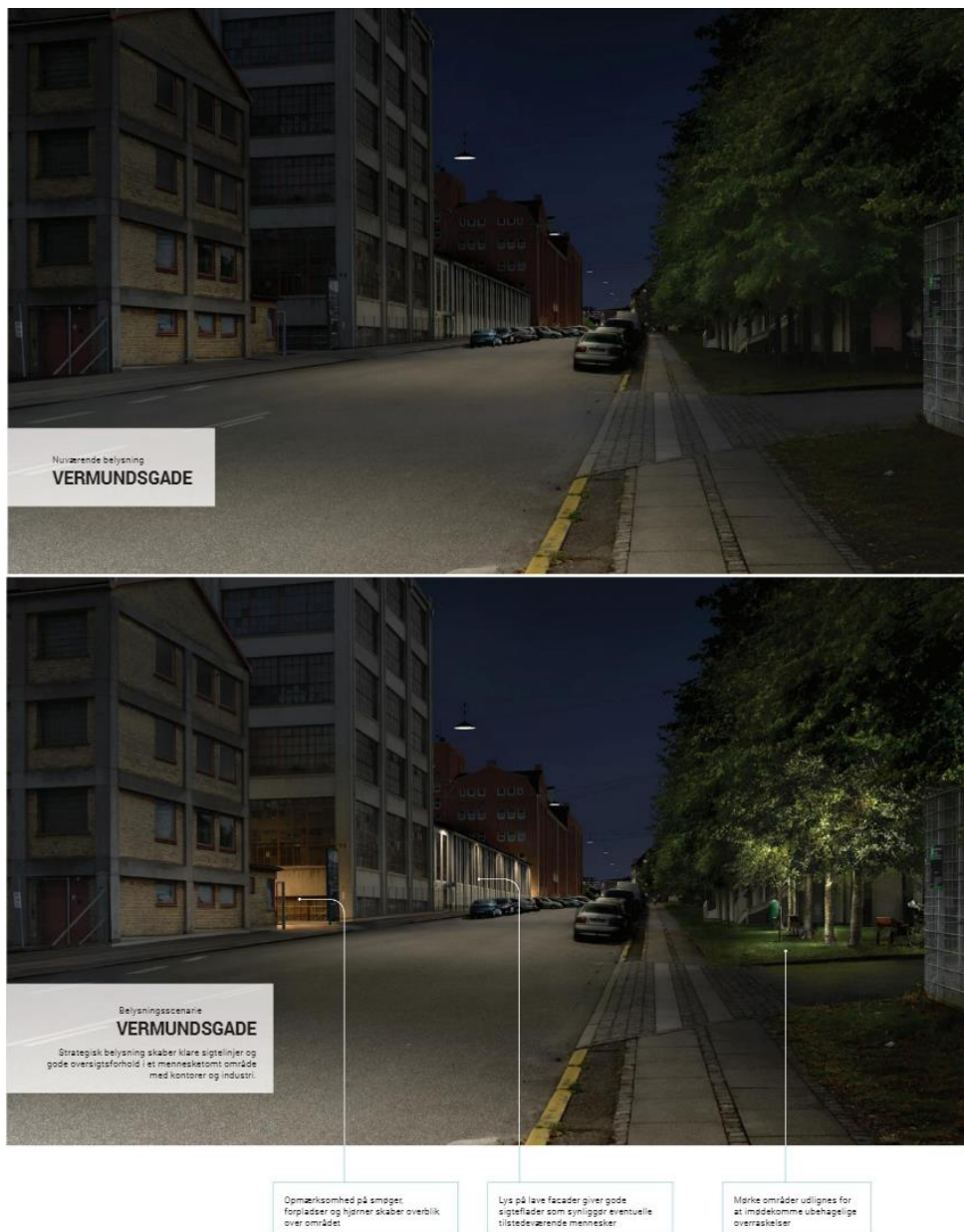
Rys. 4.27. Wizualizacja zmian w oświetleniu dla wybranej ulicy w Kopenhadze Źródło: Belysningsmasterplan for København, Citelum, 2014
