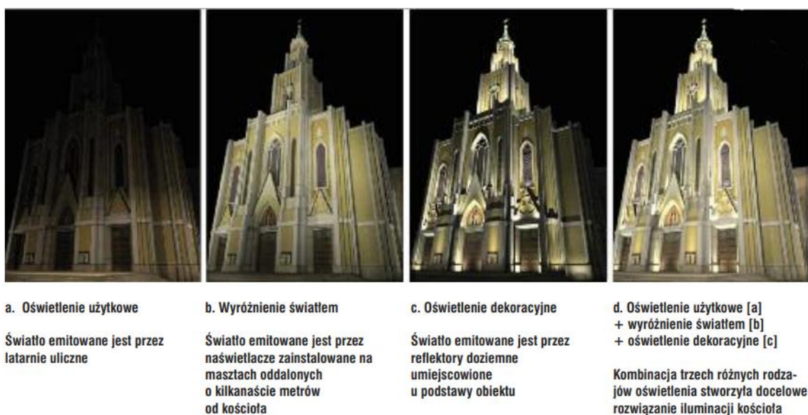
Rys. 4.32. Różnica między oświetleniem użytkowym, wyróżniającym i dekoracyjnym Źródło: Masterplan iluminacji: Warszawa światłem malowana, Studio DL, 2010
