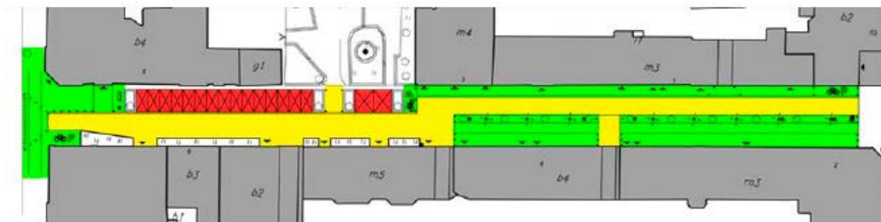
Rys.3. Planowany układ woonerfu na ulicy 6 Sierpnia w Łodzi. Kolor zielony-strefa wyłącznie dla pieszych; kolor żółty-strefa wspólna dla ruchu kołowego i pieszego; kolor czerwony-strefa z zieleniami oraz ławkami.
