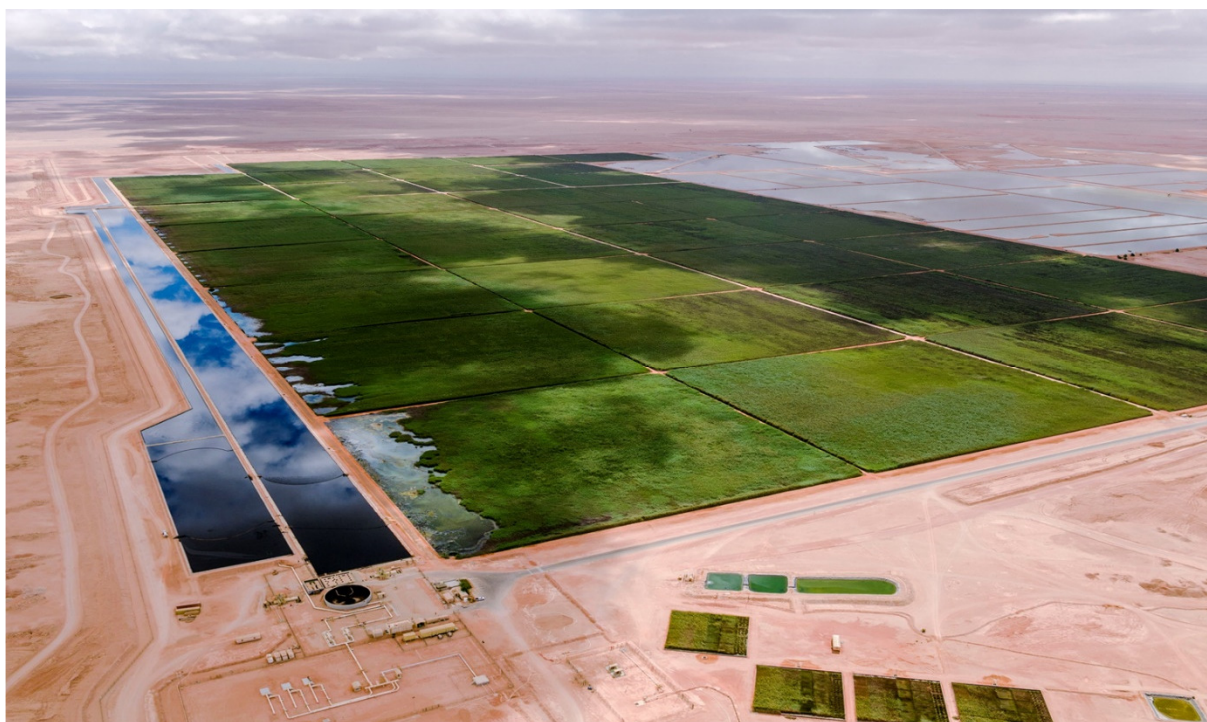
Rysunek 27 Stacja uzdatniania wody w Omanie z wykorzystaniem procesów chemicznych i biologicznych zachodzących naturalnie na podmokłych terenach, źródło: https://iees.ch/lighthouse-projects/nimr-water-treatment-plant/
