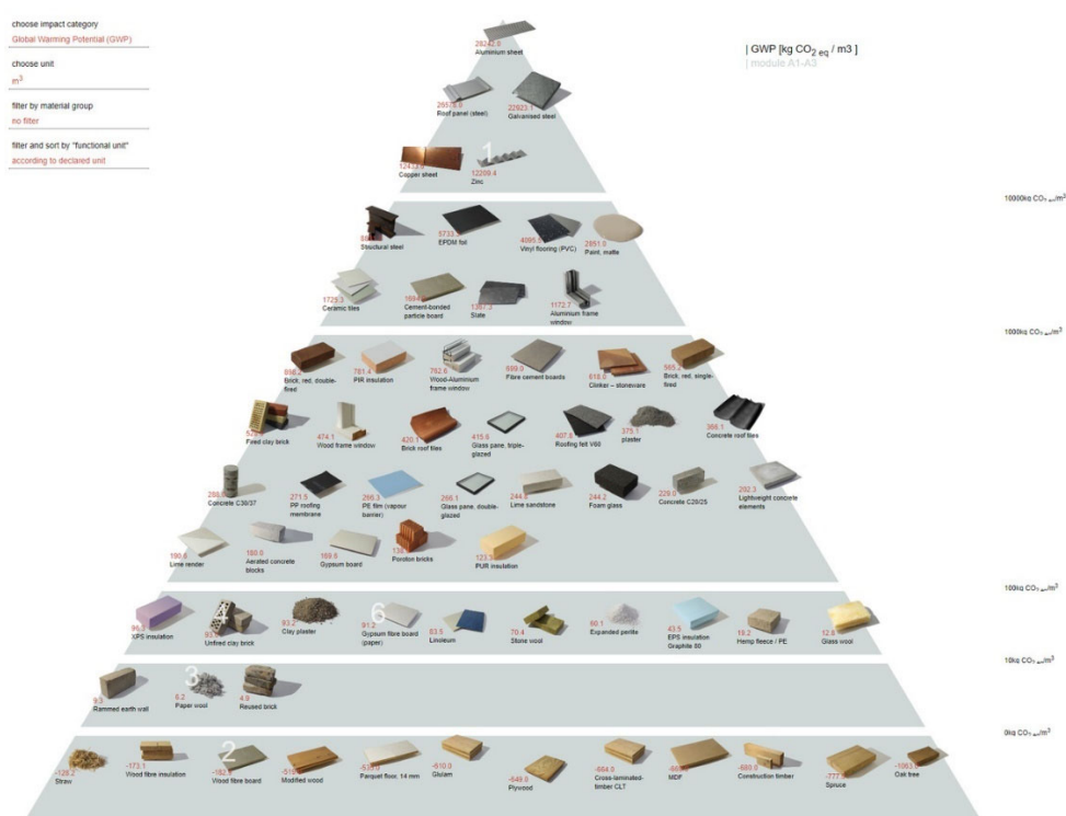
Rys. 48 Piramida materiałów budowlanych porządkuje materiały ze względu na ich wpływ na środowisko. Podstawę stanowią materiały, które powinny być stosowane najczęściej, aby zmniejszyć negatywny wpływ budynku na planetę – w powyższym przykładzie ich wpływ na globalne ocieplenie klimatu (projekt piramidy materiałów: CINARK at the Royal Danish Academy, School of Architecture and Vandkunsten, interaktywna piramida dostępna pod adresem: https://www.materialepyramiden.dk/ , grafika: https://www.archdaily.com/984663/what-is-the-environmental-impact-of-each-building-material/62bf40d1be2c390166ca23b0-what-is-the-environmental-impact-of-each-building-material-photo , data dostępu: 19.09.2022).
