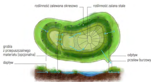
Rys. 2.10. Szczegóły techniczne stawów retencyjnych
