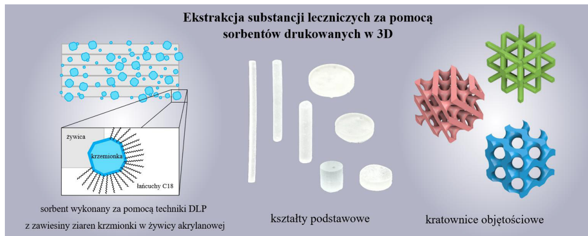
Rys. 1. Schemat budowy oraz przykłady różnych geometrii sorbentów drukowanych metodą DLP zastosowanych do ekstrakcji substancji leczniczych.
