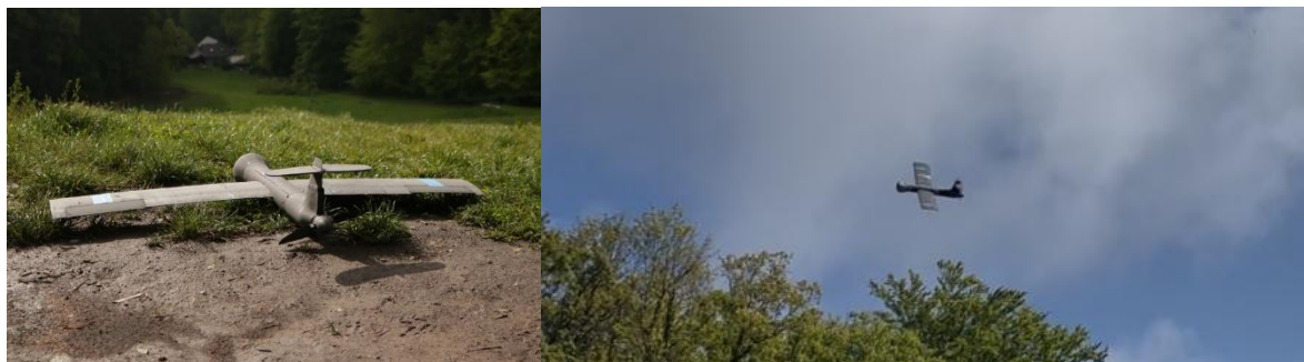
Rys. 1. Autonomiczny dron powietrzny wykorzystujący rozpoznawanie obrazu do poszukiwań ludzi zaginionych
