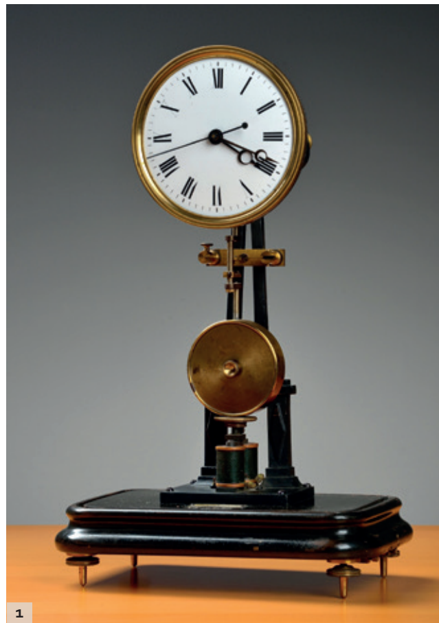
Fot. 1. Zegar wahadłowy o elektrycznym napędzie impulsującym firmy Ancienne Maison Hipp, Peyer, Favarger & Cie, pocz. XX w.
