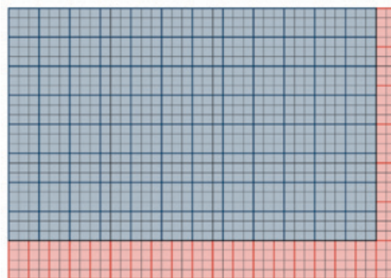
Rys. 3. Przykład optymalnego rozmieszczenia kafelków dla powierzchni 3,8 \text{ m} \times 2,8 \text{ m}
