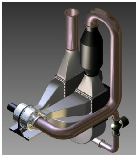
Mikrośilownia: turbospół powietrzny z zewnętrzną komorą spalania
